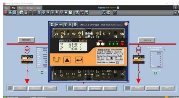
Figura 6. Interfaz gráfica del sistema general de monitoreo y control SCADA.
